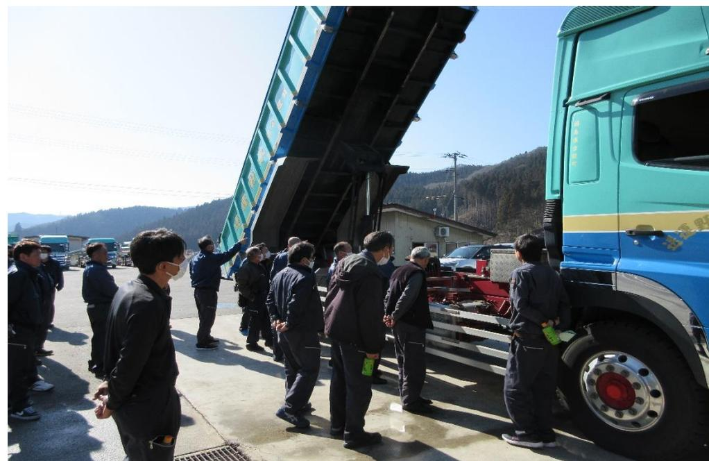
その後、脱輪・脱落事故防止のための ホイール・ナットの見える化 の 実技講習も、ボルトマーキングスプレーを使って、行いました。
